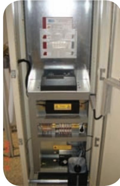
Impresión industrial de hasta 4 líneas de texto con cabezal de 32 inyectores, armario de protección con todo el conjunto de impresión listo para trabajar, con sistema de bloqueo por aproximación al cabezal de impresión.
