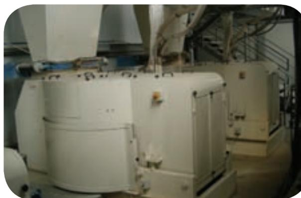
Según las necesidades del hormigón a fabricar, incluiremos en la instalación mezcladoras de eje vertical tipo planetario o mezcladoras de cuba giratoria, precedidas de eficientes sistemas de dosificación completamente automatizados, incluyendo componentes mayoritarios y también agua, aditivos (en polvo o líquido), fibras, etc.
